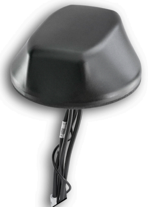
Dasa Telematics Multiple Antenna (dTMA) dTMA är anpassad för dCGW för att ge bästa möjliga mottagningsmöjlighet. dTMA har 2 st LTE-antenn, 2 st Wifi-antenn och 1 st GPS-antenn i samma kapsling.
