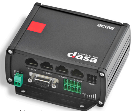
Dasa Connect Gate Way (dCGW) Gateway med LTE/3G/GSM internetuppkoppling. Enheten har intern GPS, 4 portars Ethernet-kontakt och Wifi.
